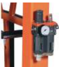
UNITÀ TRATTAMENTO ARIA F.R.L. (FILTRO REGOLATORE E LUBRIFICATORE) AIR TREATMENT UNIT F.R.L. (FILTER REGULATOR AND LUBRICATOR)
